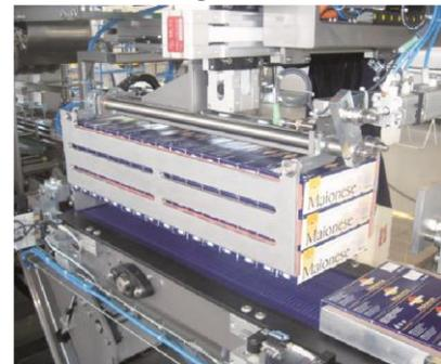
**SEPARATORE A PINZA CON IMPILATORE** Questo dispositivo a pinza controllata tramite motorizzazione brushless consente di separare e in seguito di impilare su più strati gruppi di prodotto provenienti
